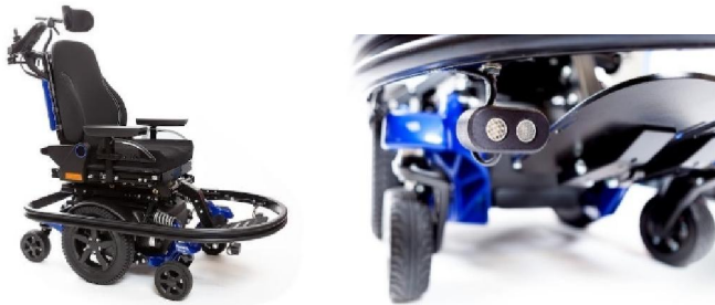
شکل ۹۸- سنسور تشخیص ماورای صوت مانع نصب شده به روی یک ویلچر هوشمند
